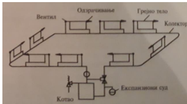
Слика 5. Тепловодно једноцијевно грејање са обилазним водовима
